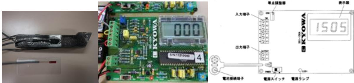
図7 バイト、ひずみゲージ、実験用ひずみゲージアンプ
